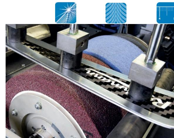
Les 2 pierres en 165mm combinées aux deux unités de diamantage permettent un travail efficace des skis jusqu'au plus haut niveau de finition.
