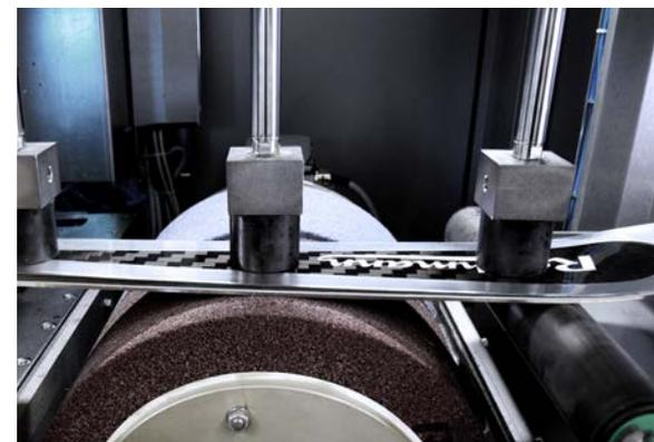
Déplacement sécurisé grâce au système de pistons ajustés automatiquement.
