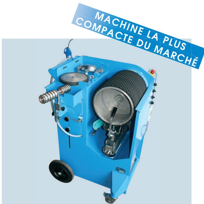
Bande de ponçage verticale = encombrement minimum.
