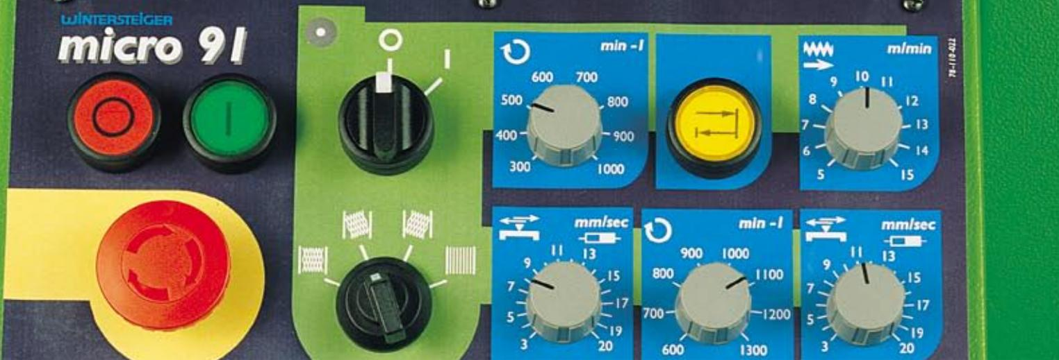
**Tout sous contrôle!** Le tableau de commande est clair et permet une saisie rapide et sûre des paramètres de travail. Tous les mouvements tels que vitesse de la pierre ou de la bande, vitesse d'avance et vitesse de diamantage sont variables et peuvent être adaptés en fonction des différentes exigences.
