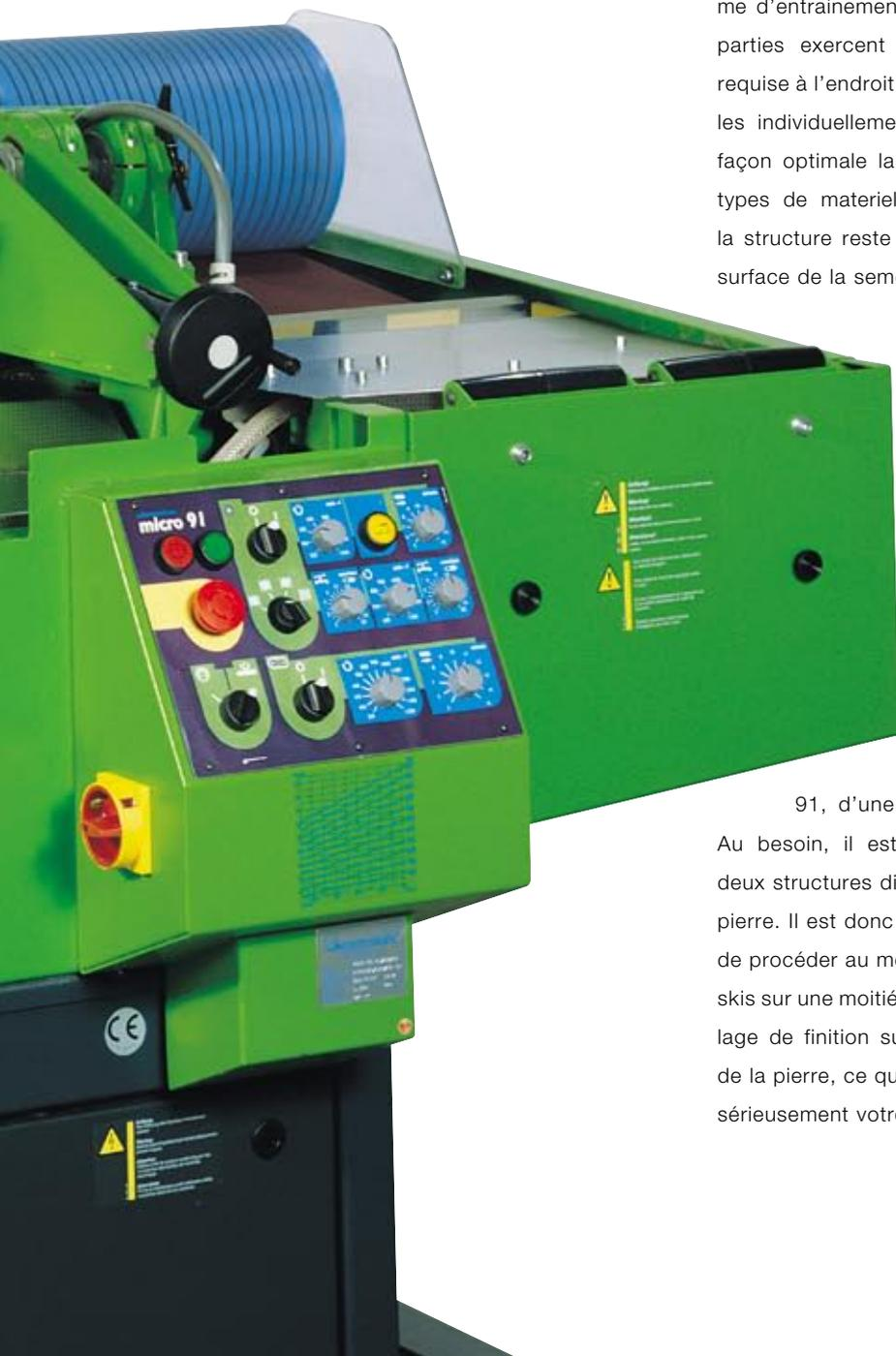
**50/50.** Toutes les variantes de structures peuvent être appliquées sur la pierre de la Micro 91, d'une largeur de 350 mm. Au besoin, il est possible d'imprimer deux structures différentes sur la même pierre. Il est donc possible par exemple de procéder au meulage d'ébauche des skis sur une moitié et d'effectuer le meulage de finition sur la deuxième moitié de la pierre, ce qui permet d'augmenter sérieusement votre efficacité.
