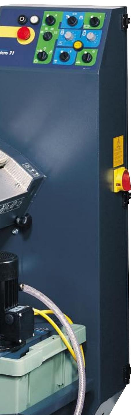
**50/50.** Toutes les variantes de structures peuvent être appliquées sur la pierre de la Micro 71, d'une largeur de 330 mm. Au besoin, il est possible d'imprimer deux structures différentes sur la même pierre. Il est donc possible par exemple de procéder au meulage d'ébauche des skis sur une moitié et d'effectuer le meulage de finition sur la deuxième moitié de la pierre, ce qui permet d'augmenter sérieusement votre efficacité.
